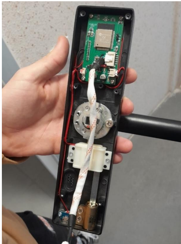
Рисунок 6 – Электронные компоненты умного электронного замка*
