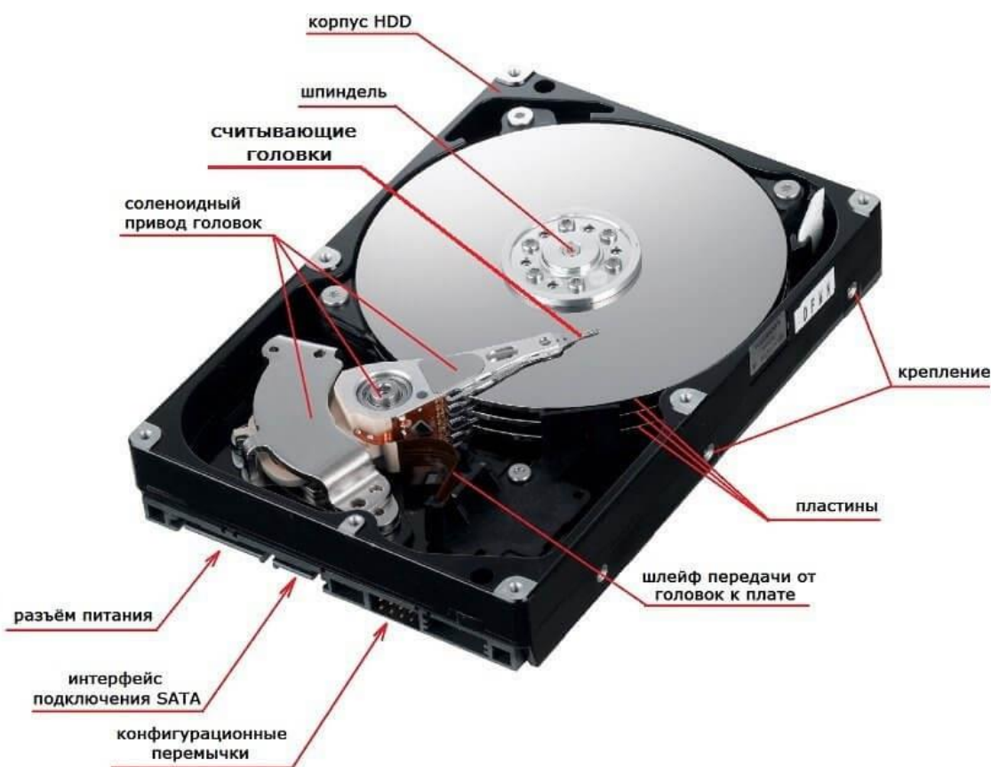
Рисунок 1. Схема жёсткого диска
